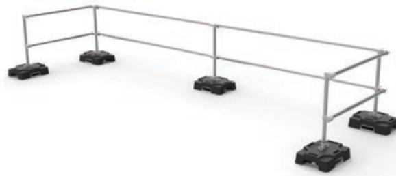
Configuration idéale lorsque l'espace au sol est réduit entre les unités à protéger et le bord du toit. Un retour de 5 pieds est nécessaire à chaque extrémité, peu importe la longueur, et à tous les 40 pieds quand il n'y a pas de parapet.
